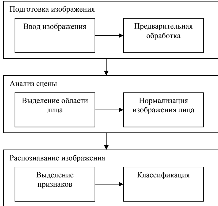
Рис. 9 Основная последовательность операций при распознавании лиц.
